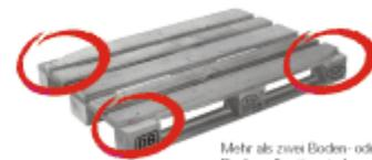
Mehr als zwei Boden- oder Deckrandbretter sind so abgesplittert, daß mehr als ein Nagel- oder Schraubenschloß sichtbar ist.
