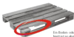
Ein Boden- oder Deckrandbrett ist so abgesplittert, daß mehr als ein Nagel- oder Schraubenschloß sichtbar ist.
