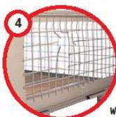
Die Rundstabgitter sind gerissen, so daß die Brakenden nach innen oder außen ragen (eine Masche pro Wand darf fehlen)
